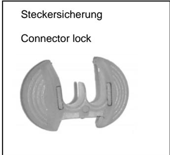
3. Knickschutz von der Original Dämpferleitung entfernen und auf die Leitung der Stilllegung montieren. Leitung der Stilllegung in die Original Buchse mit Abdichtungen ganz einschieben und einrasten. Pinposition / Kabelfarbe ist nicht relevant. Anschließend Steckergehäuse verriegeln und Knickschutz wieder anbringen
