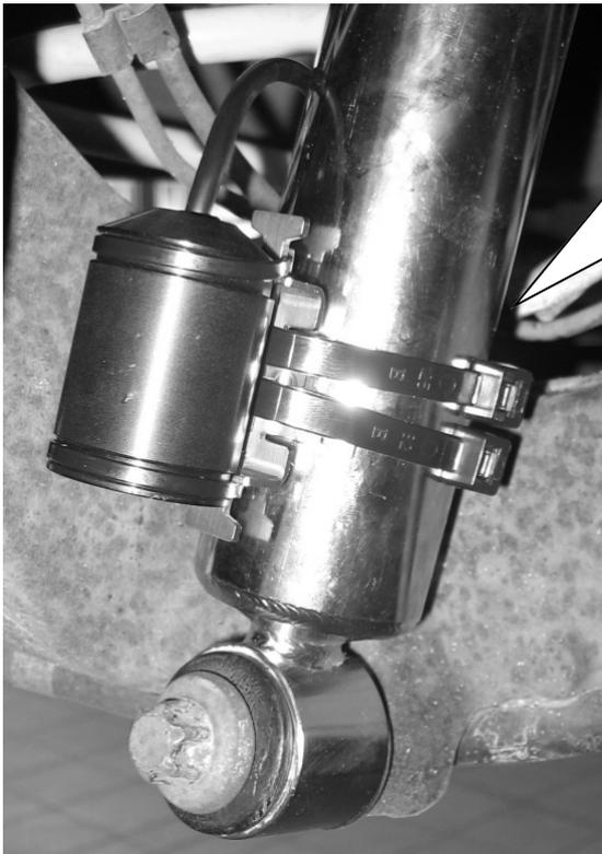
Stilllegung am Dämpfer mit dem Klebeband und Kabelbindern 4,8mm x 290mm befestigen.
