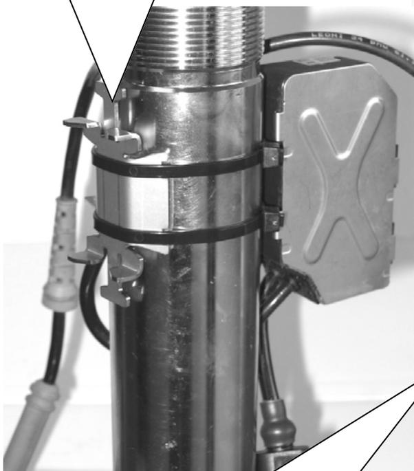
Elektronikbauteil an der Edelstahlhalterung mit Kabelbinder 4,8mm x 290mm befestigen. Zusätzlich muss die Steckverbindung mit einem Kabelbinder am Originalsteuergerät befestigt werden.
