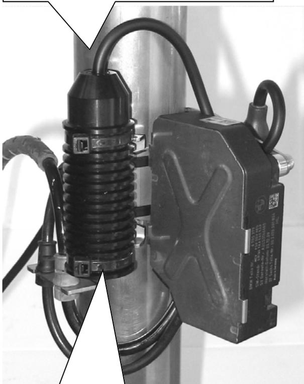
Elektronikbauteil an der Edelstahlhalterung mit Kabelbinder 4,8mm x 290mm befestigen. Zusätzlich muss die Steckverbindung mit einem Kabelbinder am Originalsteuergerät befestigt werden.
