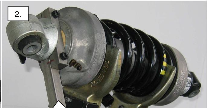
Kolbenstangenklemme wie abgebildet anbringen und fest verschrauben.
