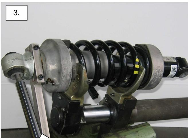
Oberes Dämpferauge wie abgebildet lösen und abschrauben.
