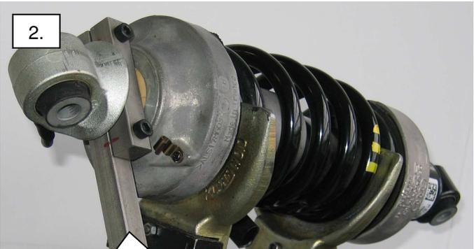
Kolbenstangenklemme wie abgebildet anbringen und fest verschrauben.
