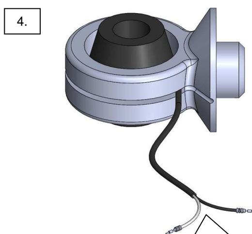
Demontieren Sie die Leitungen aus dem Kombistecker u. notieren Sie deren Position.
