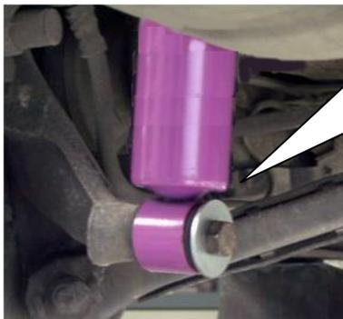
Der HA Stoßdämpfer wird montiert, wie es in den Unterlagen des Fahrzeugherstellers beschrieben wird. Sofern im Lieferumfang kein Anschlagpuffer enthalten ist, wird der serienmäßige in ungekürzter Ausführung weiterverwendet. Dieser muss sich im einwandfreiem Zustand befinden und ist ggf. zu erneuern.
