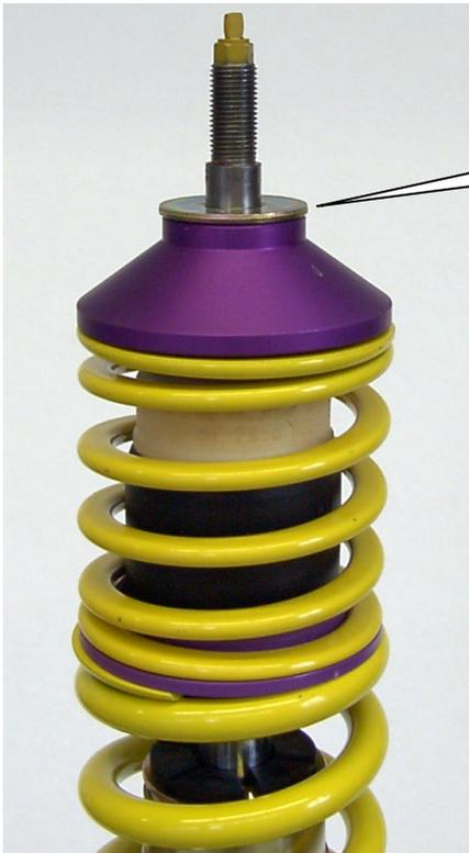
Serienmäßige Beilagscheibe muss zwischen Federteller und Stützlager montiert werden
