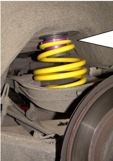
Die Höhenverstellung ( Gewindehülse und Nutenring ) ist oben an der Feder einzusetzen. Zum Korrigieren der Fahrzeughöhe ist der Stoßdämpfer an der Achse zu lösen und die Verstellung zu entlasten bzw. zu demontieren
