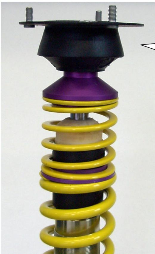
Das Original - Stützlager aufsetzen und mit der mitgelieferten Stopmutter verschrauben. Das Anzugsdrehmoment der Kolbenstangenbefestigung beträgt 40Nm. Die Einbauhinweise des Federbeines in das Fahrzeug entnehmen Sie bitte den Unterlagen des Fahrzeugherstellers
